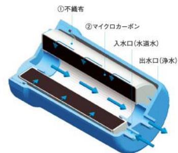
JIS規格指定の13物質(※5)に加えて、浄水器協会自主規格による3物質(※6)の除去を可能にしました。このカートリッジ1本で20ペットボトル約3,333本分(※7)の電解水素水をつくることができます。
