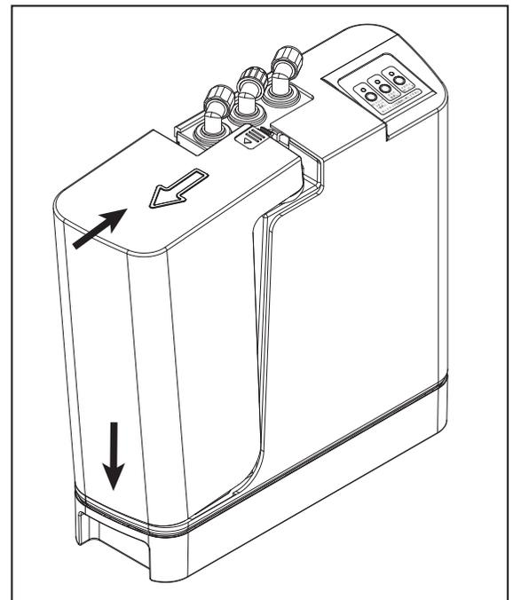
(6) 本体下部のトレーを外して、カートリッジ交換時に溜まった水を捨ててからトレーに本体を乗せてください。
