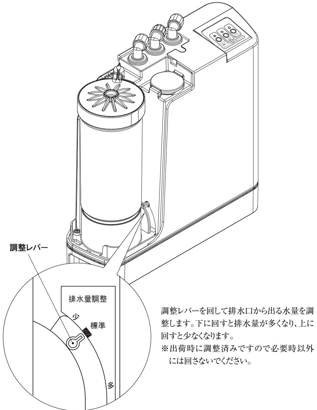
調整レバーを回して排水口から出る水量を調整します。下に回すと排水量が多くなり、上に回すと少なくなります。
