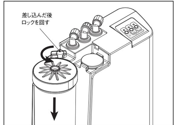
※カートリッジを差し込んだ後、必ずロックしてください。ロックが不十分だと水漏れの原因となります。(ロックが不十分な場合、カートリッジカバーを正しく取り付けることができません。)
