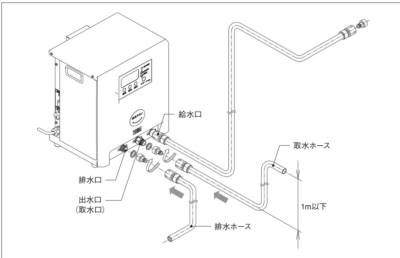
本体前面の出水口（取水口）、排水口にそれぞれ接続ホースを取り付ける。
