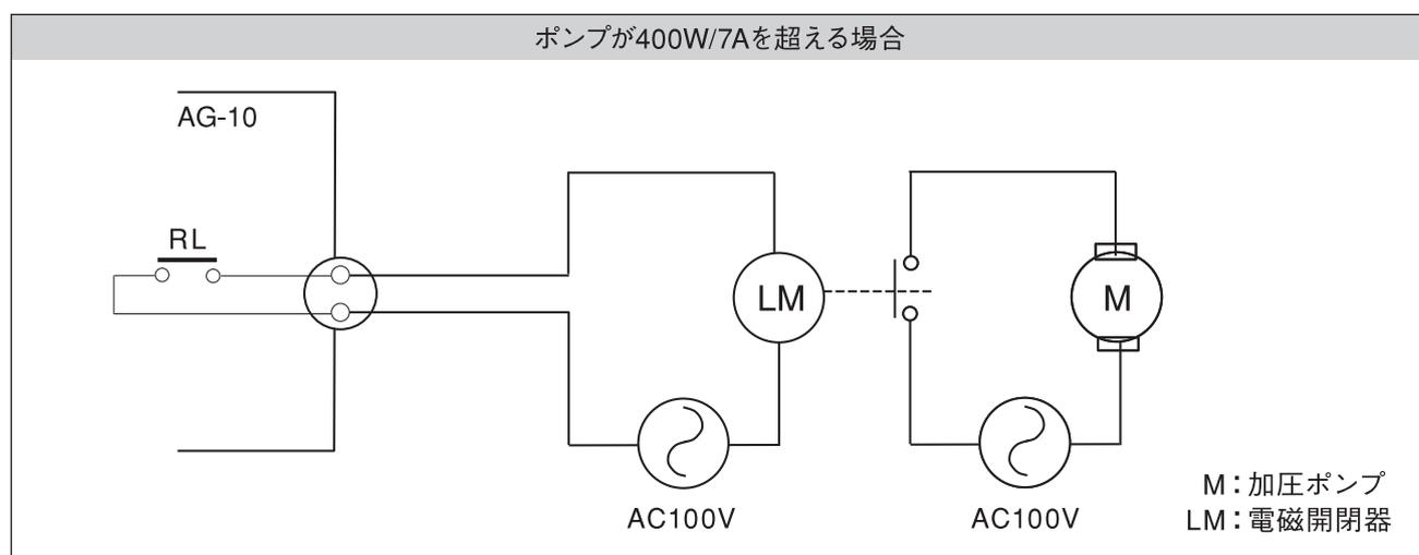
ポンプが400W/7Aを超える場合は、電磁開閉器を取付けてください。
