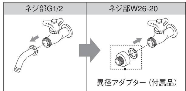
B. 給水元の配管工事が必要な場合
