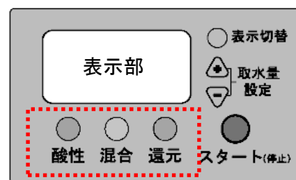
取水切替スイッチ
