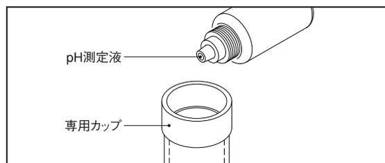
(3) 変色した電解水素水をPH比色紙表と比較してください。pH9.0～pH10.0未満が飲用に適しています。(PH比色紙表9.0～10.0の間の色)測定に使用した水は、飲まないでください。
