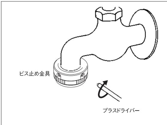
(2) 蛇口に分岐水栓のパッキンが密着するように押し上げながらビス止め金具をしっかり締めてください。
