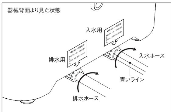
(3) 排水ホースは付属の吸盤に通し固定してください。入水ホースは接続間違いを防止するために青いラインが印刷されています。接続のときご確認ください。
