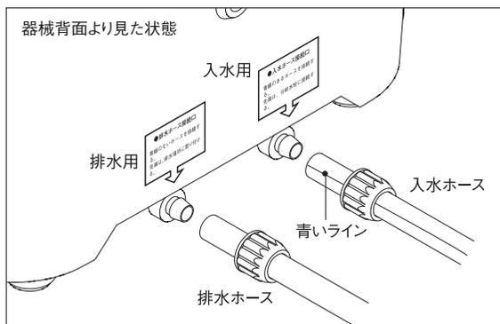
(2) 各ホースを差込口にしっかり挿入し、その後ナットにて固定してください。
