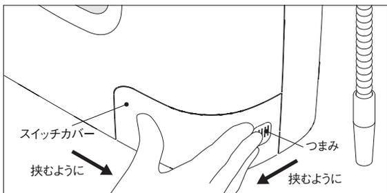
(7) レンジランプが点灯していることを確認して、本体スイッチポケットのリセットスイッチを押してください。
