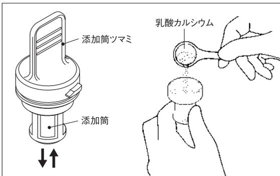
(4) 添加筒をセットした添加筒ツマミを、本体に取り付けます。この時、添加筒ツマミのOリングはみ出しやゴミ等の付着がない事をご確認ください。水漏れの原因となります。
