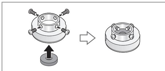
3 蛇口がねじ止め金具の中心になるようねじで固定する
