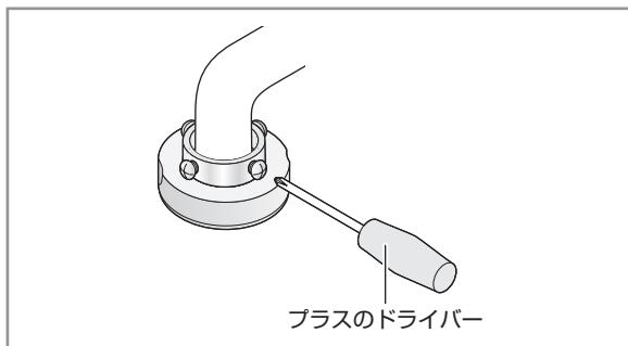
4 蛇口に分岐水栓のパッキンが密着するように押し上げる
