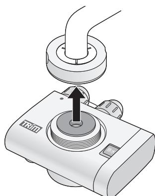
4 締付キャップをしっかりと締め付ける
