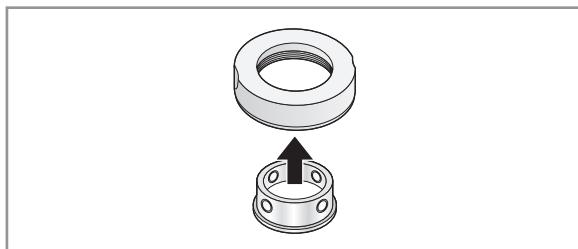
2 ねじ4本をねじ止め金具に仮止めし、平パッキンを挿入する
