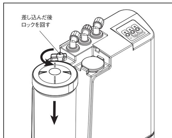
※カートリッジを差し込んだ後、必ずロックをしてください。ロックが不十分ですと水漏れの原因となります。ロックが不十分な場合、カートリッジカバーを正しく取り付けることができません。
