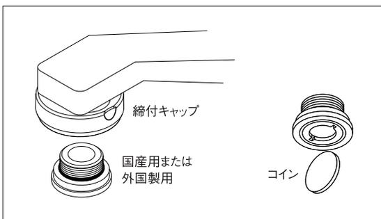
(4) 蛇口に分岐水栓のパッキンが密着するように押し上げながら、縮付キャップをしっかりと締め付けてください。
