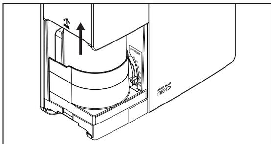
(4) カートリッジロックレバーを外して、浄水カートリッジを引き出してください。
