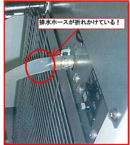
ホースが折れた場合、熱水殺菌洗浄時に10リットル以上の水が排水され排水タンク側から水が溢れ、家財等に損害を与えてしまったり、本体内に水が入り込んで故障の原因となる事が考えられます。
