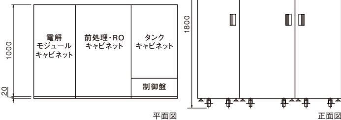
※逆浸透精製水製造システム (RO装置) 詳細については、メーカーのカタログをご参照ください。
